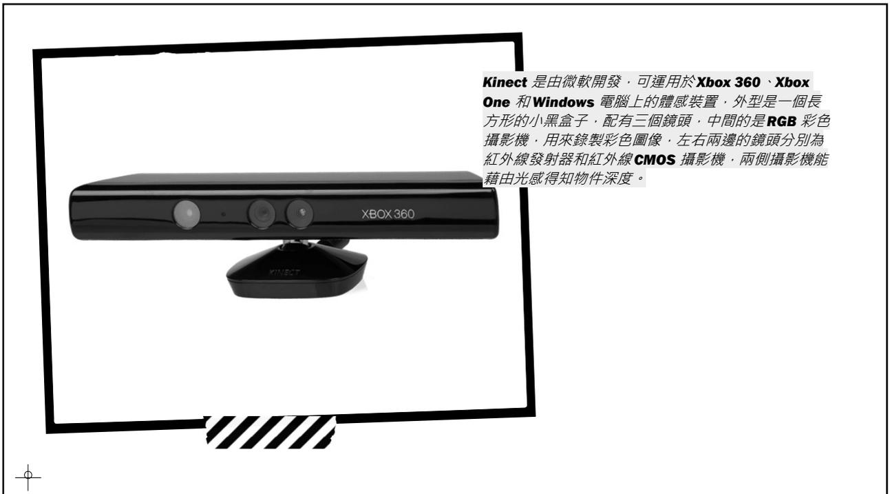
**Kinect** 是由微軟開發，可運用於**Xbox 360**、**Xbox One** 和 **Windows** 電腦上的體感裝置，外型是一個長方形的小黑盒子，配有三個鏡頭，中間的是**RGB** 彩色攝影機，用來錄製彩色圖像，左右兩邊的鏡頭分別為紅外線發射器和紅外線**CMOS** 攝影機，兩側攝影機能藉由光感知物件深度。
